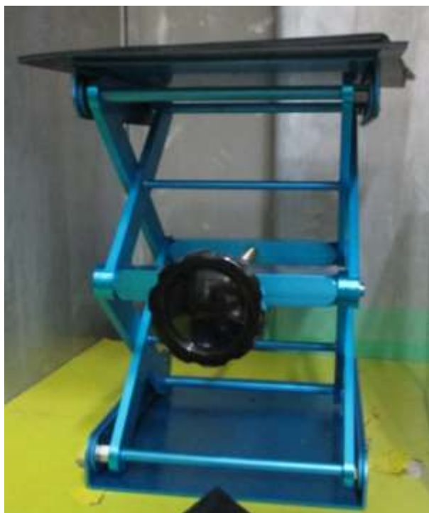
Fig. A-7 Al 容器の高さ調節に用いたジャッキ
