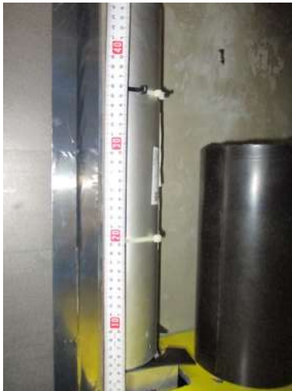
(a) 中性子発生装置
